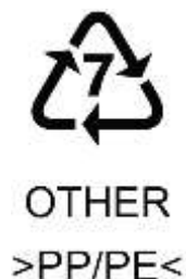
شکل ۲- نشانه‌گذاری اجزای باتری کوپلیمر پلی پروپیلن-پلی اتیلن
