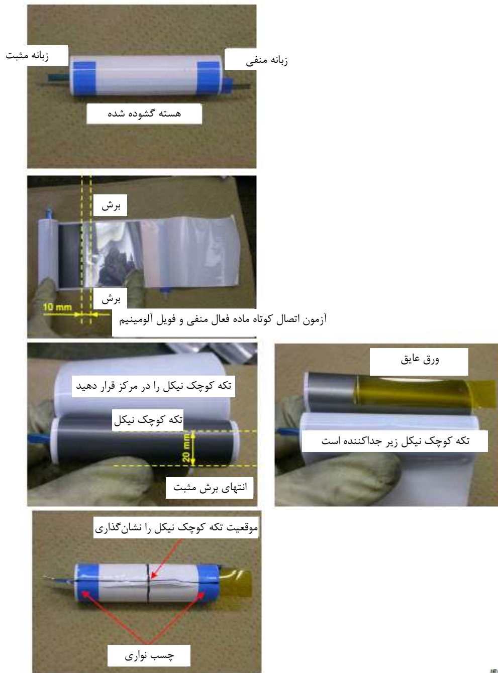
شکل الف-۶- دمونتاژ سلول استوانه‌ای
